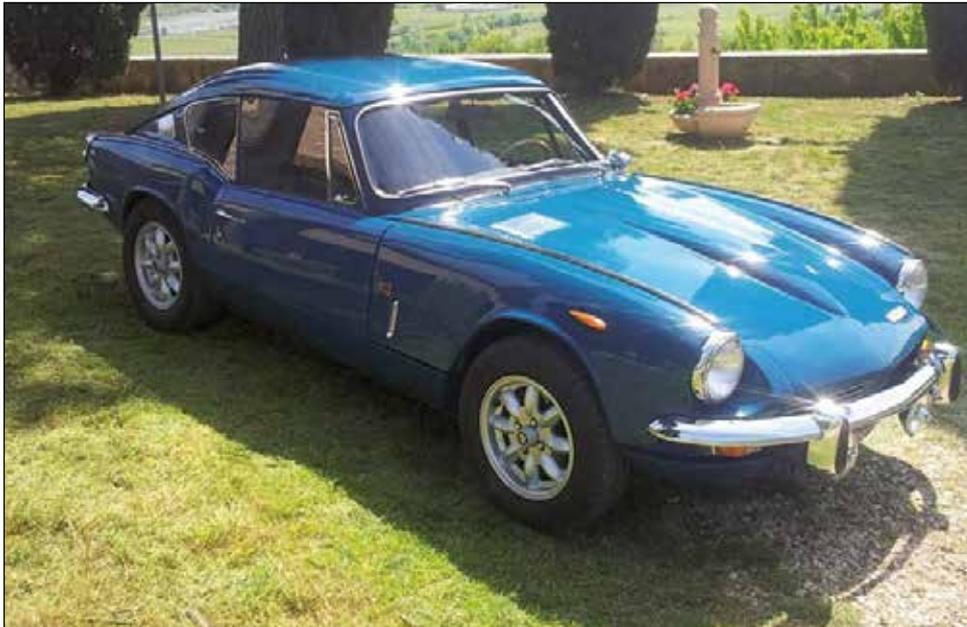
negativo sull'impianto di aerazione insufficiente e sul comportamento del retrotreno ma le vendite decollarono con successo. La seconda serie della GT6 fu presentata nel 1968 con il frontale modificato con il paraurti rialzato "con l'osso fra i denti", motore più potente (104 CV) e retrotreno modificato per mantenere costante il camber delle ruote e migliorare il
