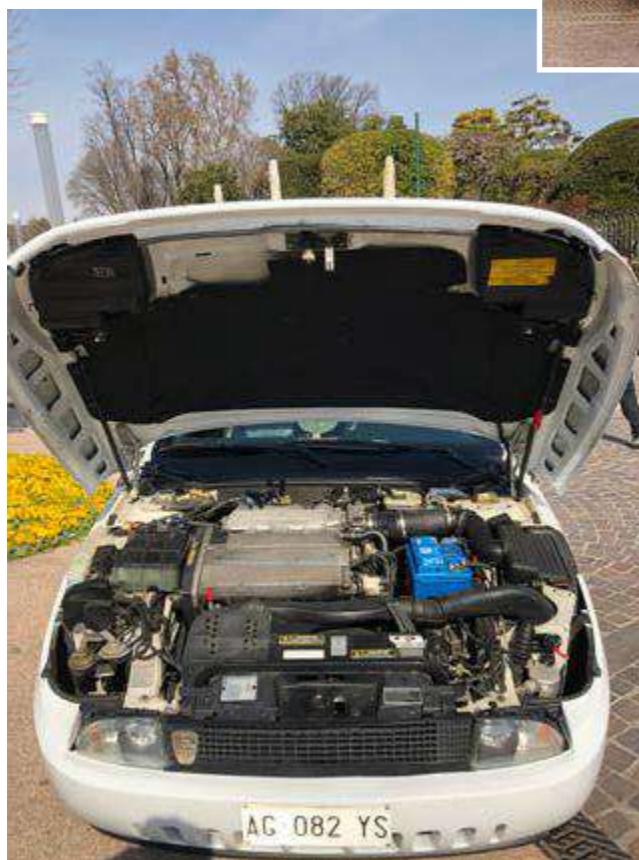
Qui sopra, il cofano motore integrale, detto anche "cofango" perché copriva la parte superiore dei parafranghi. Era molto apprezzato dai meccanici perché facilitava l'accessibilità al motore e avantreno.
