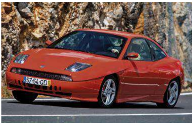
Qui sopra, il cofano motore integrale, detto anche "cofango" perché copriva la parte superiore dei parafranghi. Era molto apprezzato dai meccanici perché facilitava l'accessibilità al motore e avantreno.
