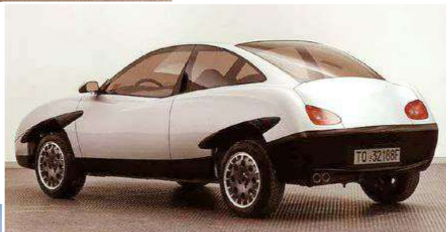
Il prototipo prescelto per lo sviluppo della nuova Coupé in cui si nota lo specchio di coda con forme ancora da definire ma dove sono già evidenziati i due baffi sui passaruota
