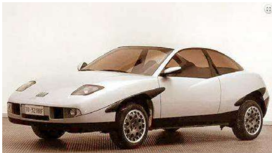
Il prototipo prescelto per lo sviluppo della nuova Coupé in cui si nota lo specchio di coda con forme ancora da definire ma dove sono già evidenziati i due baffi sui passaruota
